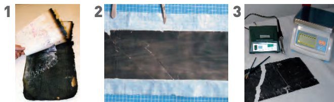
Fig. 1. Delicata fase di distacco, in ambiente umidificato, di sismogrammi sopravvissuti all'incendio di Lisbona del 1988. L'alta temperatura dell'incendio ha sciolto la lacca di fissaggio causando la creazione di pacchetti di sismogrammi incollati a due a due.
