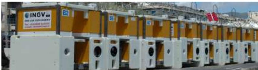
**Figura 2:** *Ocean Bottom Seismometers and Hydrophones* (OBS/H) depositi nel mar Ionio durante la campagna oceanografica SEISMOFAULTS 2017 (11-23 maggio)
