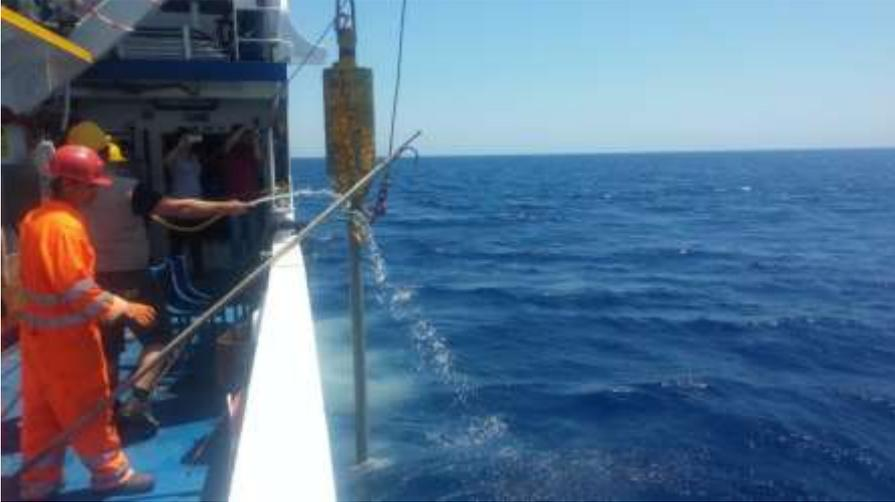
**Figura 4:** Fase di recupero dell'operazione di carotaggio
