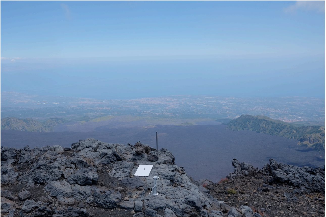
Il versante orientale dell'Etna, con la Valle del Bove e la costa ionica. In primo piano un caposaldo per la misura periodica dei movimenti del suolo.
